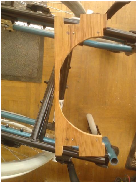
2 – pose de l'assise
